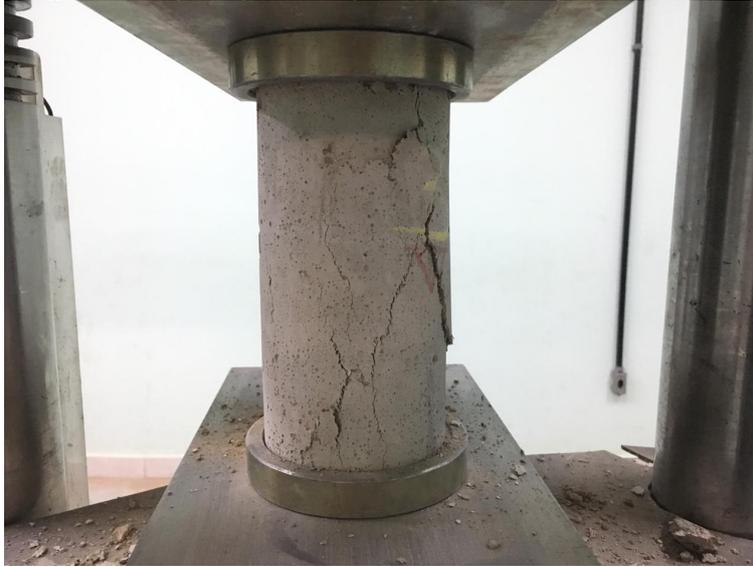
**Figura 9.** *Spalling* dos corpos de prova
