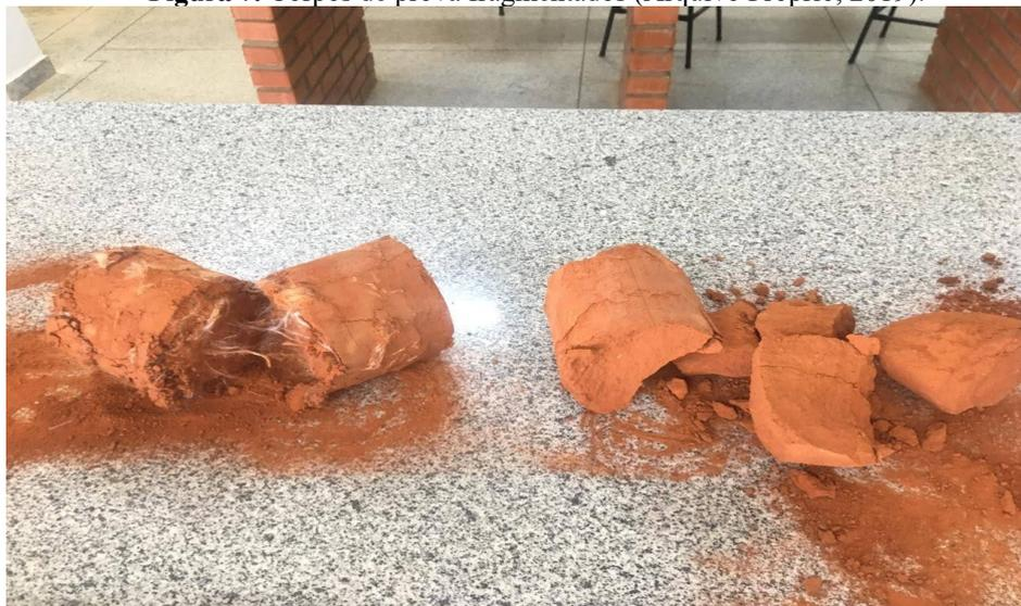
A Figura 8 detalha o modo como a fibra de polipropileno pode atribuir tenacidade ao solo. Esta consegue aderir ao mesmo de forma que sejam um material de diferentes fases, mas que tenham comportamento de homogeneidade, impedindo a dispersão que o solo poderia sofrer com a atuação de forças. A fibra de polipropileno age como um ligante entre as
