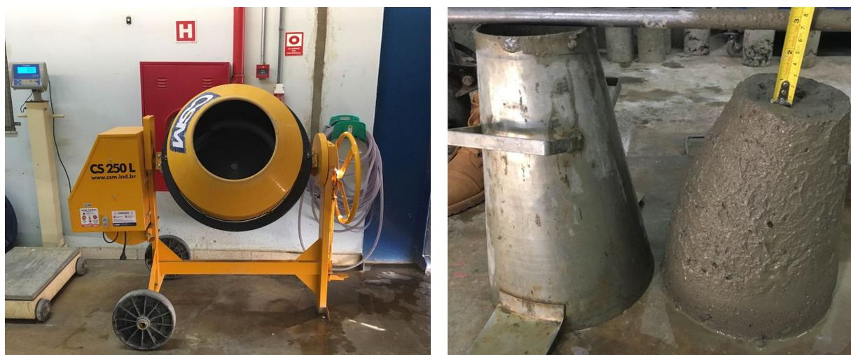
Após a realização do slump test, os corpos de prova foram moldados (Figura 3. a). Após 24 horas, os corpos de prova foram desmoldados (Figura 3. b) e levados para a câmara úmida onde foram armazenados em uma caixa d'água em solução de água e cal hidratada durante 6 dias em temperatura ambiente (Figura 3. a).
