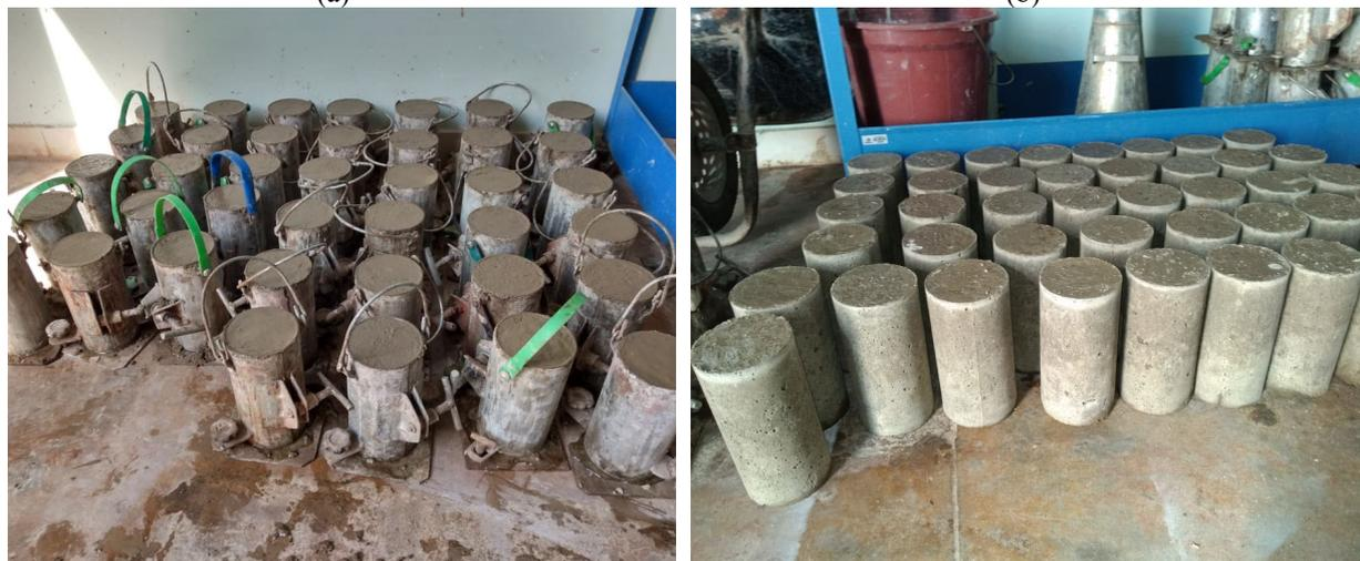
Passado este período, os corpos de prova foram retirados da solução e dispostos em ambiente de laboratório por aproximadamente duas horas para posteriormente serem submetidos aos ensaios conforme a Figura 4 (b). O processo foi repetido para todas as adições propostas neste trabalho.
